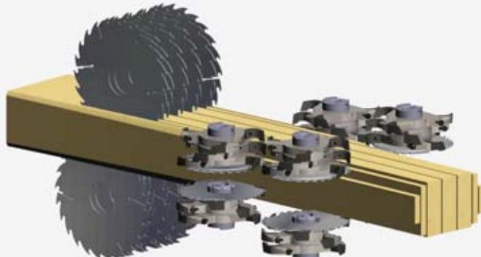
Делительный блок распиливает брус и оптимизированно фрезерует четыре боковые доски.
