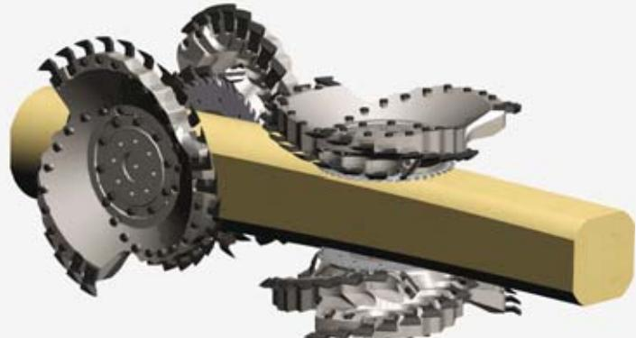
Брусующий станок обрабатывает путем брусьования четыре поверхности бревна
