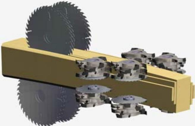
Пильный блок пишит и фрезеровальным блоком оптимизированно фрезерует четыре боковые доски.
