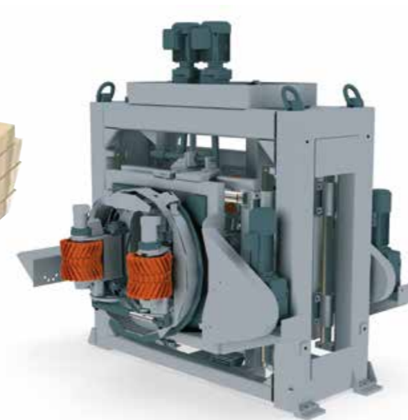
Tarkkuutta tukinsyöttöön HewSaw LogIn -tukinsuuntauslaitteistoilla.
